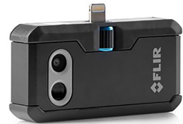
2015년: FLIR One. iPhone 및 Android 휴대폰에 장착하는 액세서리로 무게는 36g입니다.
